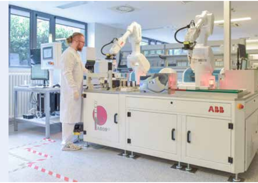
Markierungen auf dem Fußboden zeigen an, bei welcher Entfernung die Roboterarme stoppen.
