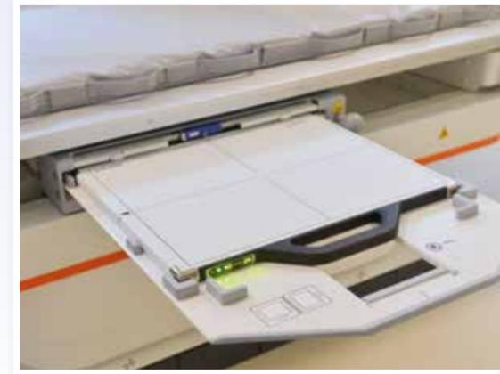
*Herzstück der modernen digitalen Röntgen-Geräte: Detektor mit röntgensensitiven Dioden.*
